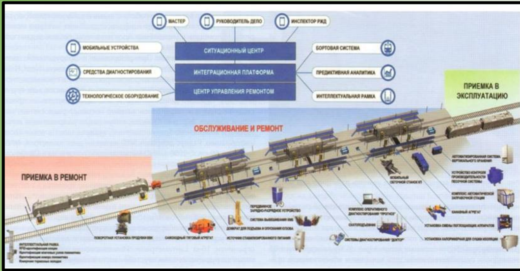
Структура универсальной цифровой канавы в сервисном локомотивном депо «Братское»
